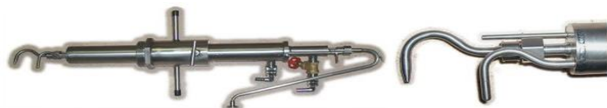
写真出典:グリーンブルー株式会社ホームページ“ダイオキシン類長期自動採取装置”
